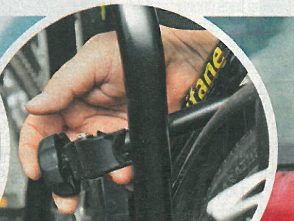
Bullwing SR4: Die Rahmenkralle ist im Fahrversuch gebrochen
