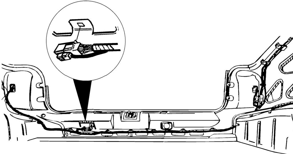
Vorhandenes Steckhülsegehäuse von Steckverbindung 9-fach abziehen.
